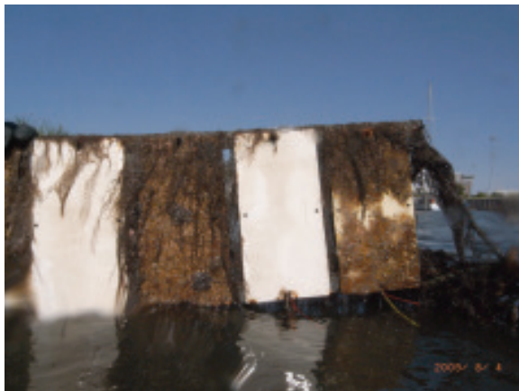
Abb.11 links: Algenanzuchtplatten nach 4 Monaten im Hooksmeer, rechts, Algenanzuchtplatten nach 4 Monaten in der Jade.
